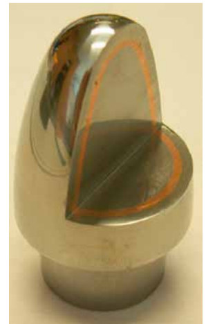
Prinzip der L-DED-Technologie und additiv gefertigter Bauteil aus unterschiedlichen Materialien.
