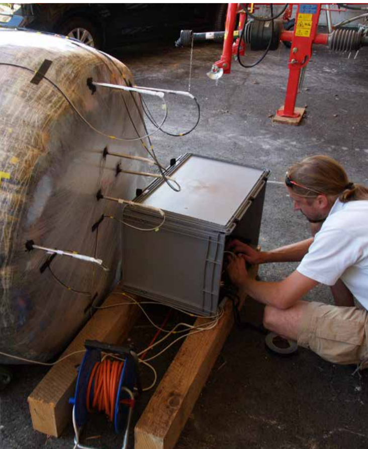
◀ Mit Sensor-Stickern wird der Sauerstoffgehalt im Siloballen gemessen.
