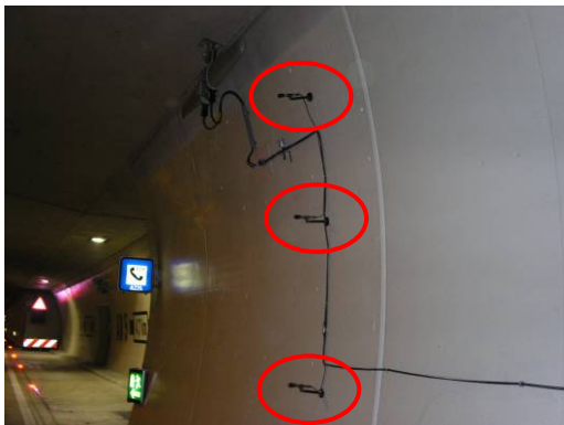
Abbildung 9 & Abbildung 10 Mehrere Mikrofone wurden zur Bestimmung der optimalen Position sowohl in vertikaler als auch in horizontaler Richtung montiert
