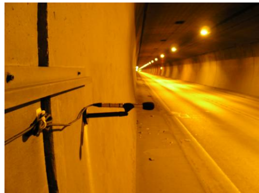
Abbildung 9 & Abbildung 10 Mehrere Mikrofone wurden zur Bestimmung der optimalen Position sowohl in vertikaler als auch in horizontaler Richtung montiert
