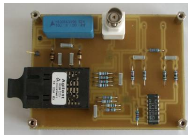
Abbildung 4: Prototyp der Platine mit Transceiver und XLR-Converter auf der „Empfängerseite“ [1]
