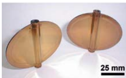
Abb. 2: Drosselklappen aus CF-Verbundwerkstoff, beschichtet mittels der HybridPLD bei Raumtemperatur mit einem auf Titanitrid basierendem Mehrschichtsystem.
