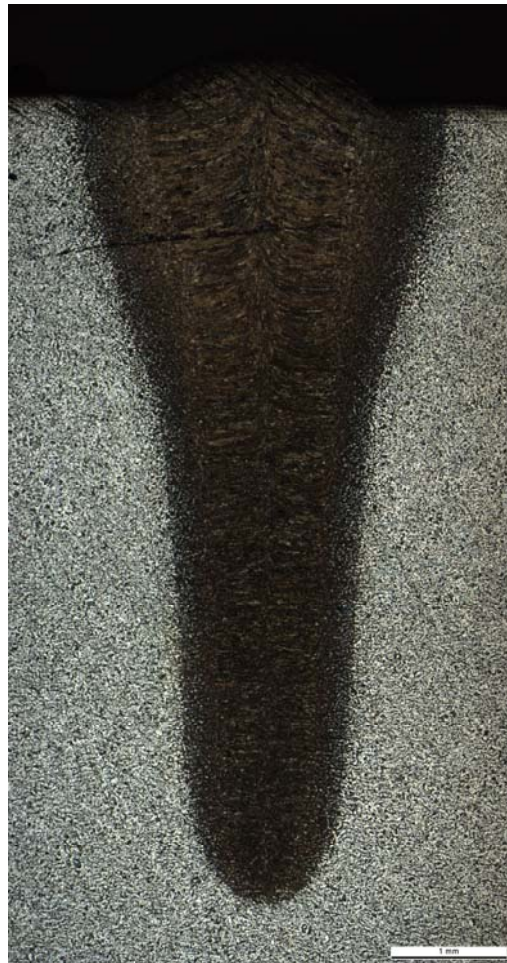
Abbildung 4: Blindschweißung mit 5kW und 2m/min
