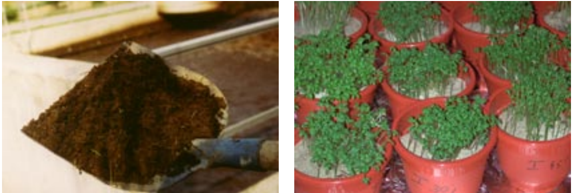
Abb. 31 : Endprodukt - vererdeter Klärschlamm – Pflanzenverträglichkeitstest mit Kresse
