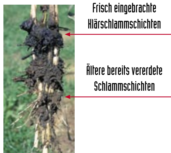
Abb.13: Beispiel für die „Zonierung“ in einem Vererdungsbecken
