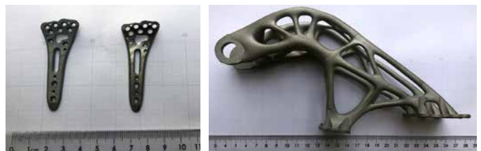
Praxisbeispiele aus der Medizin und der Luft- und Raumfahrt (links: Knochentafeln, rechts: Schmier für Wartungsklappe eines Triebwerks jeweils aus Titan)
