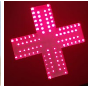
Praxisbeispiel 3D-gedrucktes Fluglinien-Emblem mit integrierten LEDs und Kontaktierung durch elektrische Leiterbahnen aus Kupfer, hergestellt mittels ADPB.
