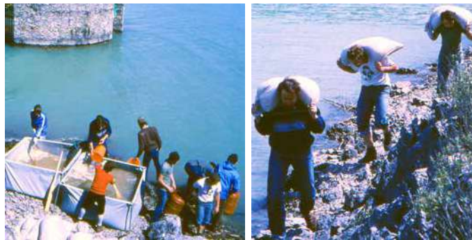
Auflösung und Einspeisung des Tracers in eine Katavothre im Becken von Feneos
