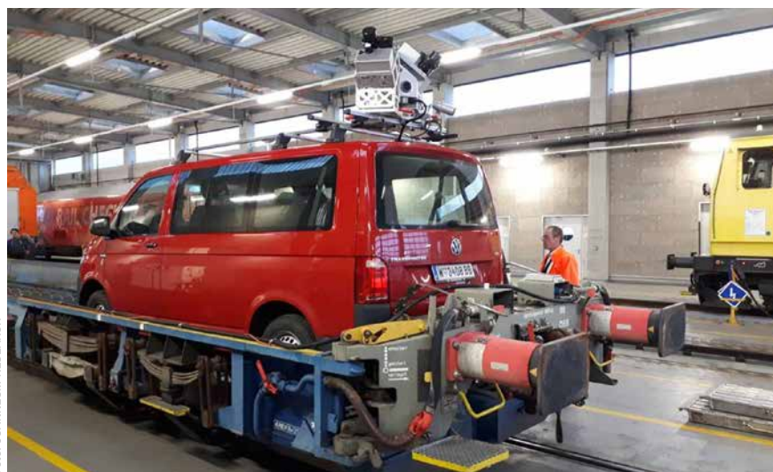
Das Fahrzeug mit dem mobilen Vermessungsaufbau wird auf die Schienen gebracht. Das hat rein praktische Gründe, denn der Aufbau direkt auf Wagons wäre schwieriger.
