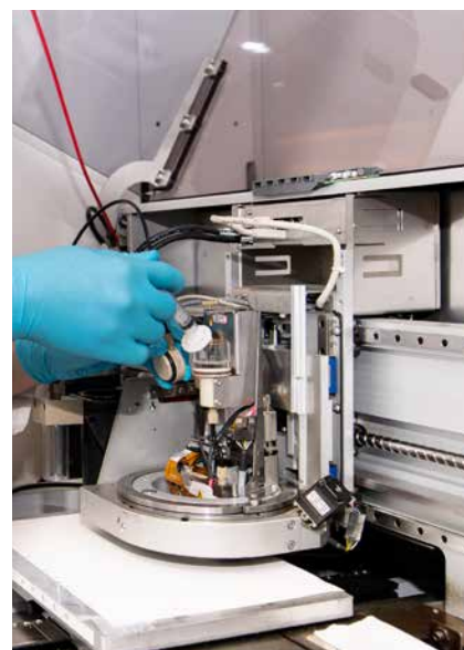
Mit dem neuen Inkjetdrucker im Reinraum lassen sich staubfrei empfindliche Mikrostrukturen drucken.
