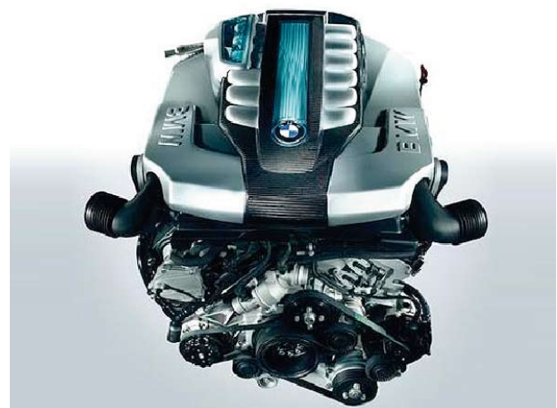
Abbildung 8: Wasserstoff-Verbrennungsmotor (BMW AG)
