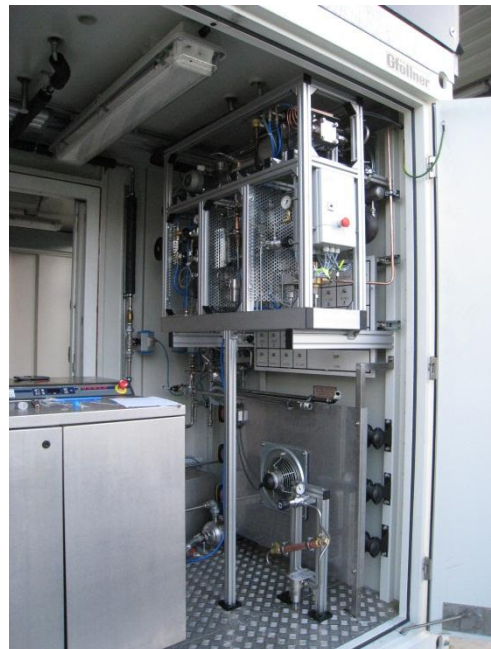
Abbildung 3-31: Anlagenmodul „Sauerstoff“ integriert am HyCentA
