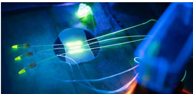
Die Offene Mikroperfusion (OFM) ermöglicht die kontinuierliche Gewinnung der interstitiellen Flüssigkeit (ISF) für (prä-)klinische Studien zur Arzneimittelentwicklung und Biomarkerforschung. Foto: Bergmann
